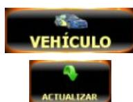
2) Al presionar el ícono **VEHÍCULO**, completar con el Tipo de Bobina, la Cantidad de Cilindros, Tipo de Tps y el Tps Mínimo, después presionar la tecla **ACTUALIZAR** para grabar los cambios en el módulo X5. Verificar con el motor en marcha lenta que los gráficos de RPM están entre 800 y 950 RPM y el gráfico de TPS muestra el valor mínimo.
